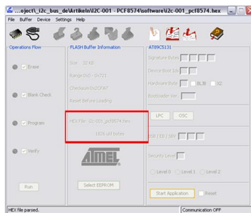
Abbildung 31 Flip - Hex-File überprüfen
